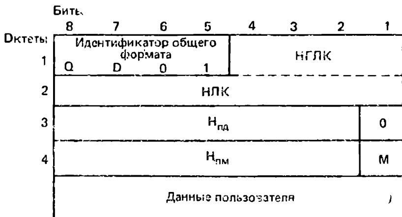
Рис. 4.7. Форматы пакетов «Данные ООД» (а) и «Данные АКД» (б)
